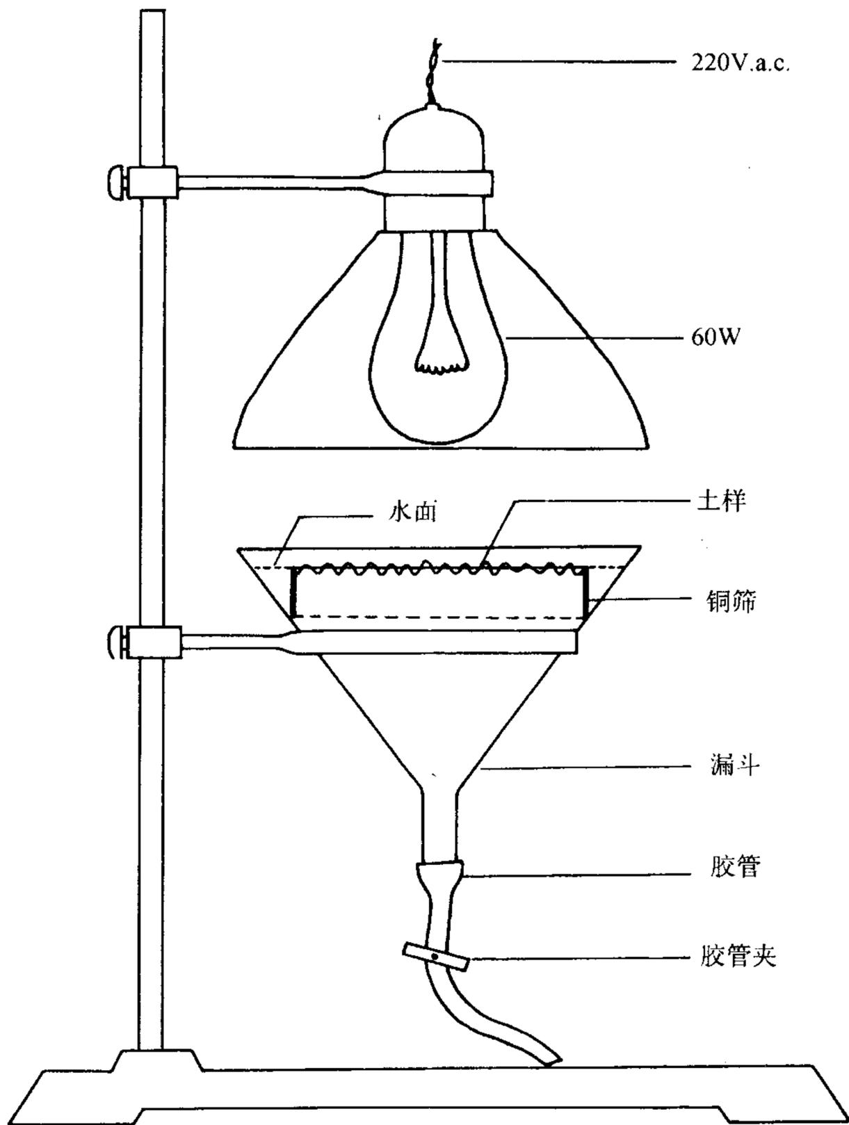
图 4-6-1 土壤小蚓分离装置(湿漏斗)的剖面示意图
